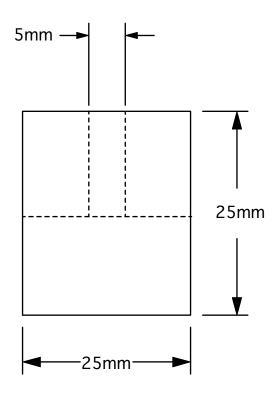
MATERIAL: CAST ALNICO, PAINTED RED & MAGNETIZED WEIGHT: 120 g PULL FORCE: 9.0 kg
